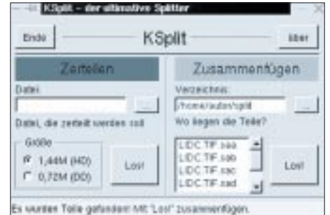
Bild 9: Die einzelnen „Splitterdateien“ werden von den Disketten in ein eigenes Verzeichnis kopiert und dann mit Programmen wie „KSplit“ wieder zusammengefügt.
