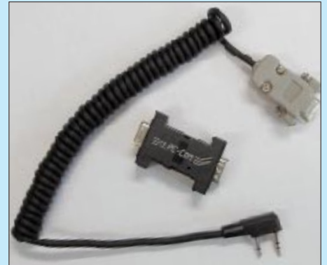
Dieses Steckermodem (Mitte) erlaubt den Einstieg in das Packet-Radio-Netz mit 1200 Baud; auf saubere Ausführung der Kabelverbindung zum Funkgerät ist zu achten. Fotos: FA
