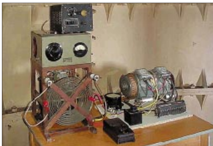
Der zweite Löschkunten sender mit Umformer und Stellwiderstand im Kleinen Leuchtturm Borkum
