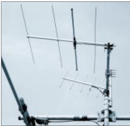
Klein und trotzdem für den Anfang ausreichend; das Anstellen beider Antennen um etwa 20° nach oben ist ein guter Kompromiß.
