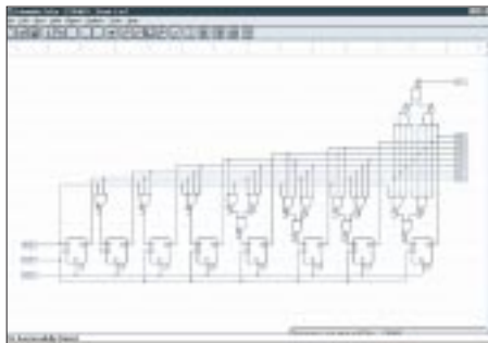
Bild 27: Der 8-Bit-Zähler ist fertig.
