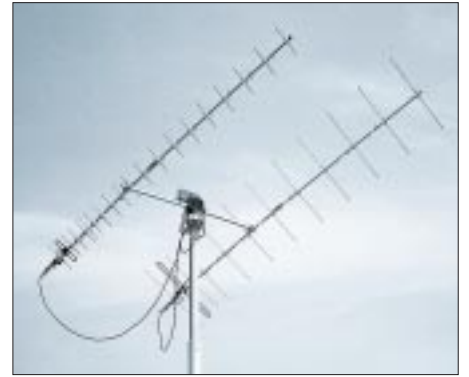
Die klassische Kreuzyagikombination am Horizontal-/Vertikal-Rotor – beste Wahl, doch kein Muß. Fotos: DL4EEC (2)
